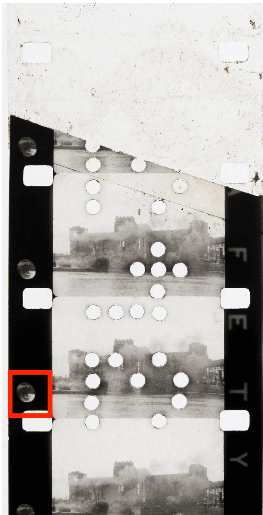
Figure 21 Marques de caméra laissées en marge de la fenêtre de prise de vues. Ciné-Kodak model B (objectif 20 mm, f/3,5 ). Photogrammes de films 16 mm. CQ, « Collection Adrien-Hébert ». Acquisition en 1978 (07182). Photographe : Eva Létourneau.
